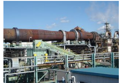
J X 金属苫小牧ケミカル ロータリーキルン式焼却炉
